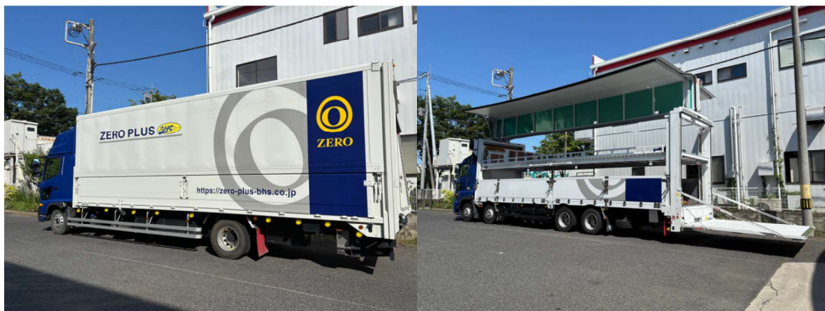
開閉式の屋根とリフト式の後部扉を備えたバイク輸送車
